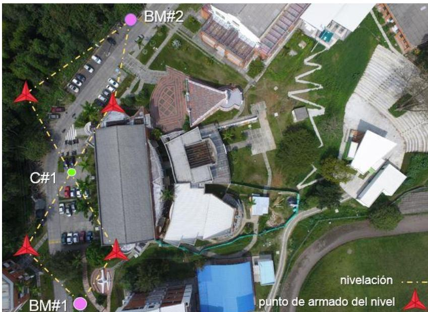
Figura 19. Doble altura instrumental<sup>19</sup>
