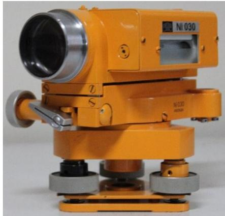
**Figura 4.** Nivel basculante, Ni 030 Carl Zeiss<sup>4</sup>
